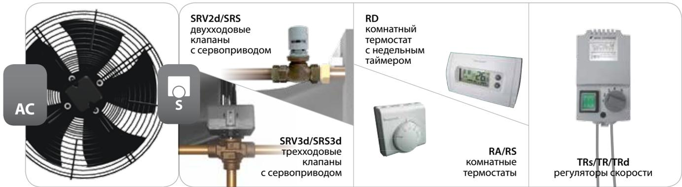
Это самая простая система управления ON/OFF. Работа отопительного аппарата регулируется термостатом, который включает аппарат в случае падения температуры в помещении ниже заданной. Регулировка производительности вентилятора происходит при помощи пятиступенчатого регулятора скорости.
